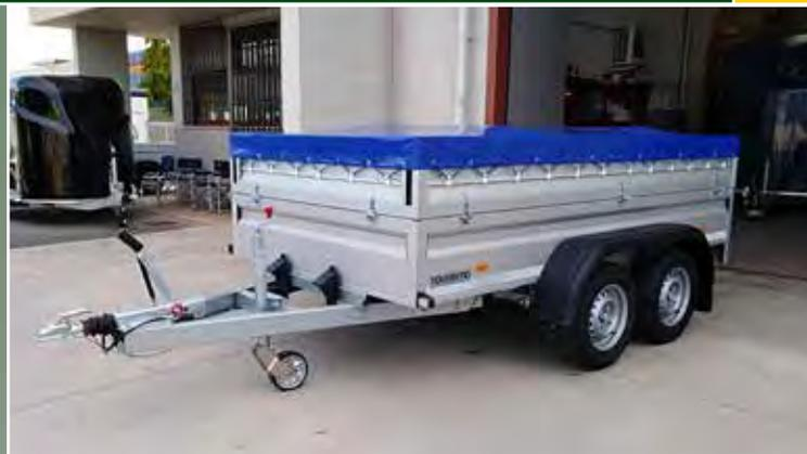
**Struttura, sponde e profilati in alluminio anodizzato**
