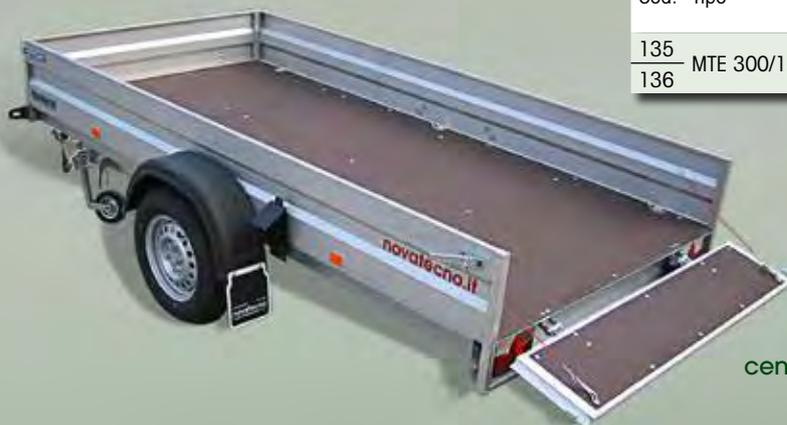
Accessori: ruota di scorta - kit sovrasponde - telo piano centinatura e telone - piedini d'appoggio - rampe di carico sponda anteriore apribile
